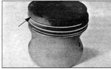
11. Nesimetrinis stūmoklio dilimas rodo švaistiklio galvutės nesimetriškumą
