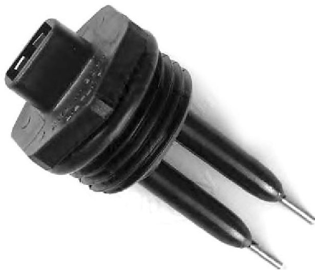
6.17 pav. Aušinamojo skysčio lygio jutiklis
