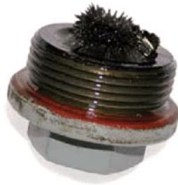
3.42 pav. Alyvos išleidimo kamštis su magnetu
