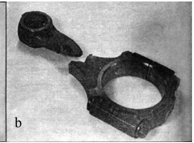
29. Cilindro hidraulinio smūgio rezultatas: a) švaistiklio deformacija; b) švaistiklio lūžis
