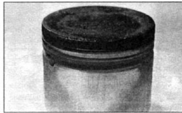
14. Stipriai išdilusi viršutinė stūmoklio dalis
