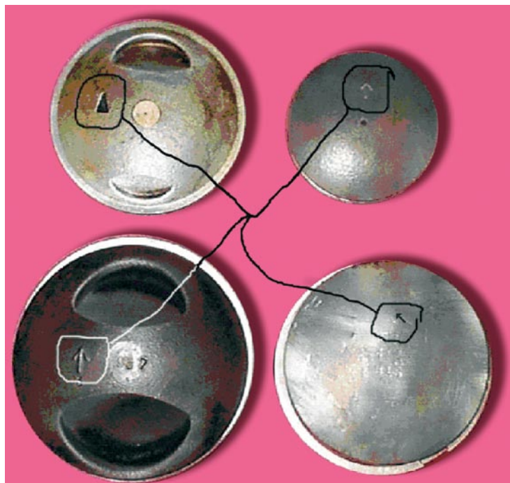
11.5 pav. Stūmoklių orientavimo žymės
