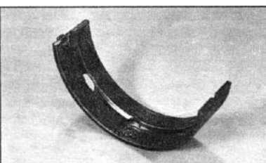
27. Pašalinės dalelės slydimo guolio darbiniam paviršiuje dėl sudilusių kitų variklio detalių
