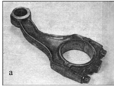
29. Cilindro hidraulinio smūgio rezultatas: a) švaistiklio deformacija; b) švaistiklio lūžis
